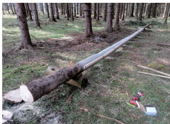
Obrázok 1. Kmeň rozdelený do sekcií, sekcie sú izolované od prostredia nylonovou sieťovinou
